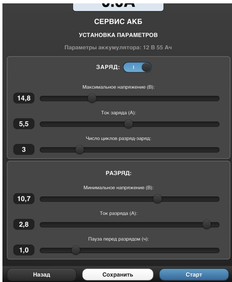
Рис. 18 - Установка параметров заряда и разряда
